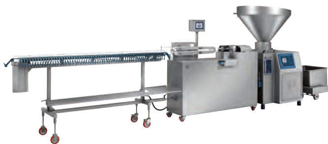
Die Längenabdreheinheit ist mit einem Aufhängegerät kombinierbar.
