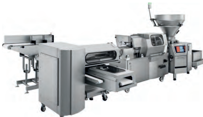
Das Gruppier-System ist geeignet für das vollautomatische Handling von Frischwurst unter anderem im Natur- und Collagendarm oder in der Alginathülle.
