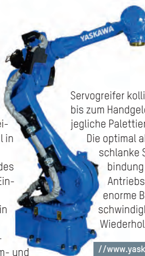
Der neue Motoman PL80 palettiert Lasten bis 80 kg.
